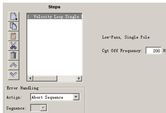
单极点的低通滤波器，请在文本框中输入截止频率。范围：1-1500
